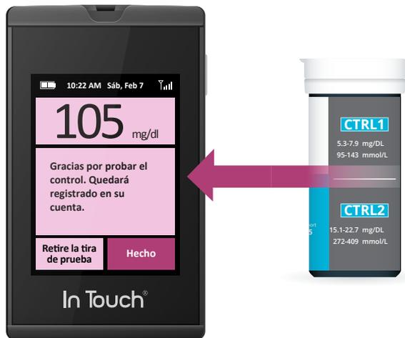
8. Compare el resultado en la pantalla con el rango impreso en el frasco de la tira de prueba y la bolsa de aluminio. Si el resultado se encuentra dentro del rango, el monitor y las tiras de prueba están funcionando correctamente.
